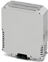
Custodie per guide DIN, Custodia completa con piedino di fissaggio in metallo, design alto, con feritoie di ventilazione, larghezza: 35,2 mm, altezza: 99 mm, profondità: 113,65 mm, colore: grigio chiaro (simili RAL 7035), collegamento trasversale: Connettore bus per guide DIN (opzionale), n. poli connettore trasversale: 5
