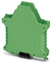
Custodie per guide DIN, Base custodia con piedino di fissaggio in metallo, design alto, senza feritoia di ventilazione, larghezza: 22,6 mm, altezza: 99 mm, profondità: 107,3 mm, colore: verde (simili RAL 6021), collegamento trasversale: Connettore bus per guide DIN (opzionale), n. poli connettore trasversale: 5
