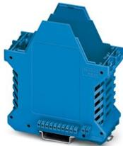
Custodie per guide DIN, Base custodia con piedino di fissaggio in metallo, con 2 contatti FE, di tipo alto, con feritoie di ventilazione, larghezza: 45,2 mm, altezza: 99 mm, profondità: 107,3 mm, colore: blu (simili RAL 5015), collegamento trasversale: connettore bus integrato, n. poli connettore trasversale: 10+2, Connettore bus: 10 contatti paralleli, 2 contatti seriali
