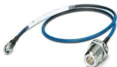
Cavo per antenna per passacavo per armadio elettrico, diametro esterno: 3,2 mm, conduttore interno: flessibile, attenuazione: 0,6 / 0,9 / 1,4 dB a 0,9 / 2,4 / 5,8 GHz, connessione: N (femmina) -> RSMA (maschio), lunghezza cavo: 0,5 m
