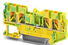
Morsetti comp. per conduttori terra, numero di connessioni: 4, tipo di connessione: Connessione Push-in, Sezione di dimensionamento: 2,5 mm<sup>2</sup>, sezione: 0,14 mm<sup>2</sup> - 4 mm<sup>2</sup>, tipo di montaggio: NS 35/7,5, NS 35/15, colore: giallo-verde
