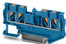
Morsetto passante, tensione nominale: 800 V, corrente nominale: 24 A, numero di connessioni: 4, tipo di connessione: Connessione Push-in, Sezione di dimensionamento: 2,5 mm<sup>2</sup>, sezione: 0,14 mm<sup>2</sup> - 4 mm<sup>2</sup>, tipo di montaggio: NS 35/7,5, NS 35/15, colore: blu
