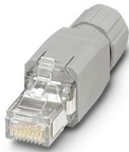
Connettore RJ45, tipo: RJ45, grado di protezione: IP20, numero poli: 8, 1 Gbit/s, CAT5, materiale: Plastica, tipo di connessione: Connessione a perforazione di isolante, sezione di connessione: AWG 26- 23, uscita cavo: diritto, colore: grigio traffico A RAL 7042, Ethernet
