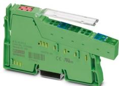
Inline, Morsetto uscita digitale, Uscite digitali: 4, 24 V DC, tecnica di connessione: 3 conduttori, Variante per condizioni estreme:, velocità di trasmissione nel bus locale: 500 kBit/s, grado di protezione: IP20, connettore Inline e cartellini di siglatura incl.
