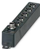
Unmanaged Switch 1600 serie, 5 Porte M12 10/100 MBit/s, grado di protezione: IP65/IP66/IP67, Temperatura ambiente (esercizio): -40 °C ... 70 °C, Intervallo di tensione di alimentazione: 9 V DC ... 32 V DC, PROFINET Conformance-Class A
