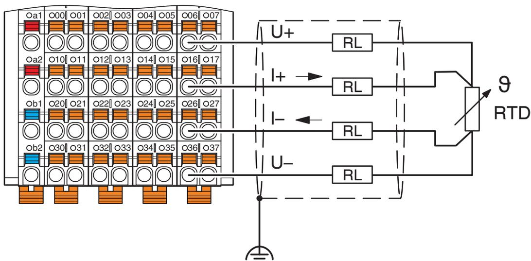
Esempio di collegamento: connessione a 4 conduttori
