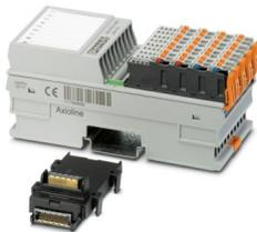
Axioline F, Modulo per il rilevamento della temperatura, Ingressi analogici: 8 (per sensori di temperatura resistivi), tecnica di connessione: 2, 3, 4 conduttori (schermati), velocità di trasmissione nel bus locale: 100 MBit/s, grado di protezione: IP20, incluso modulo di base bus e connettori Axioline F
