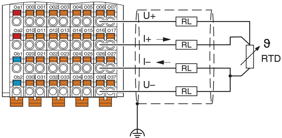
Esempio di collegamento: connessione a 4 conduttori per sensore a 3 conduttori con linee molto lunghe (> 100 m)
