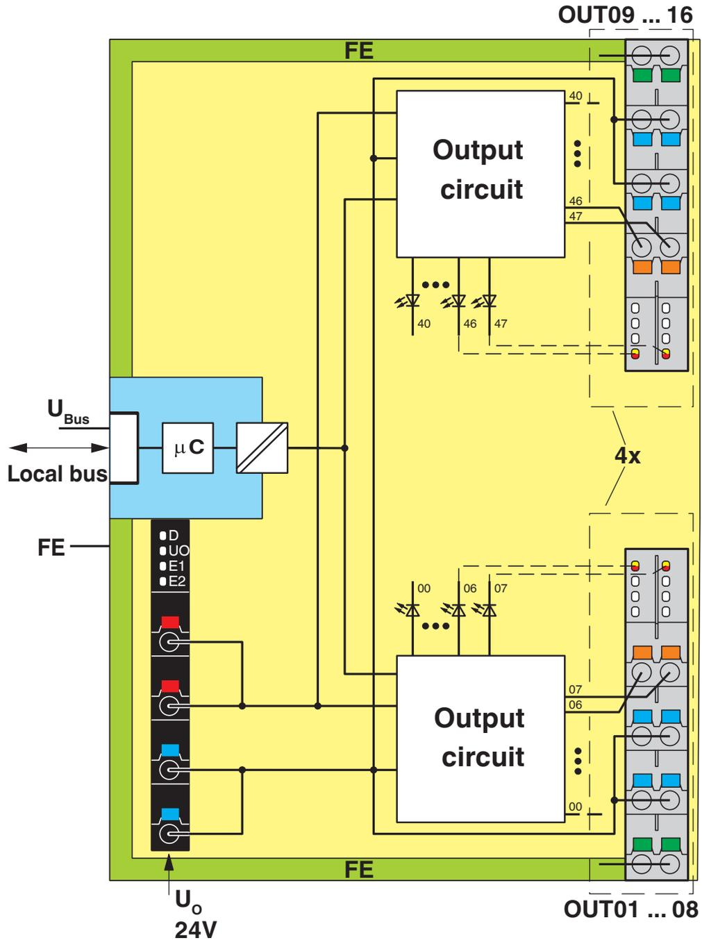
Circuito interno dei punti di connessione
