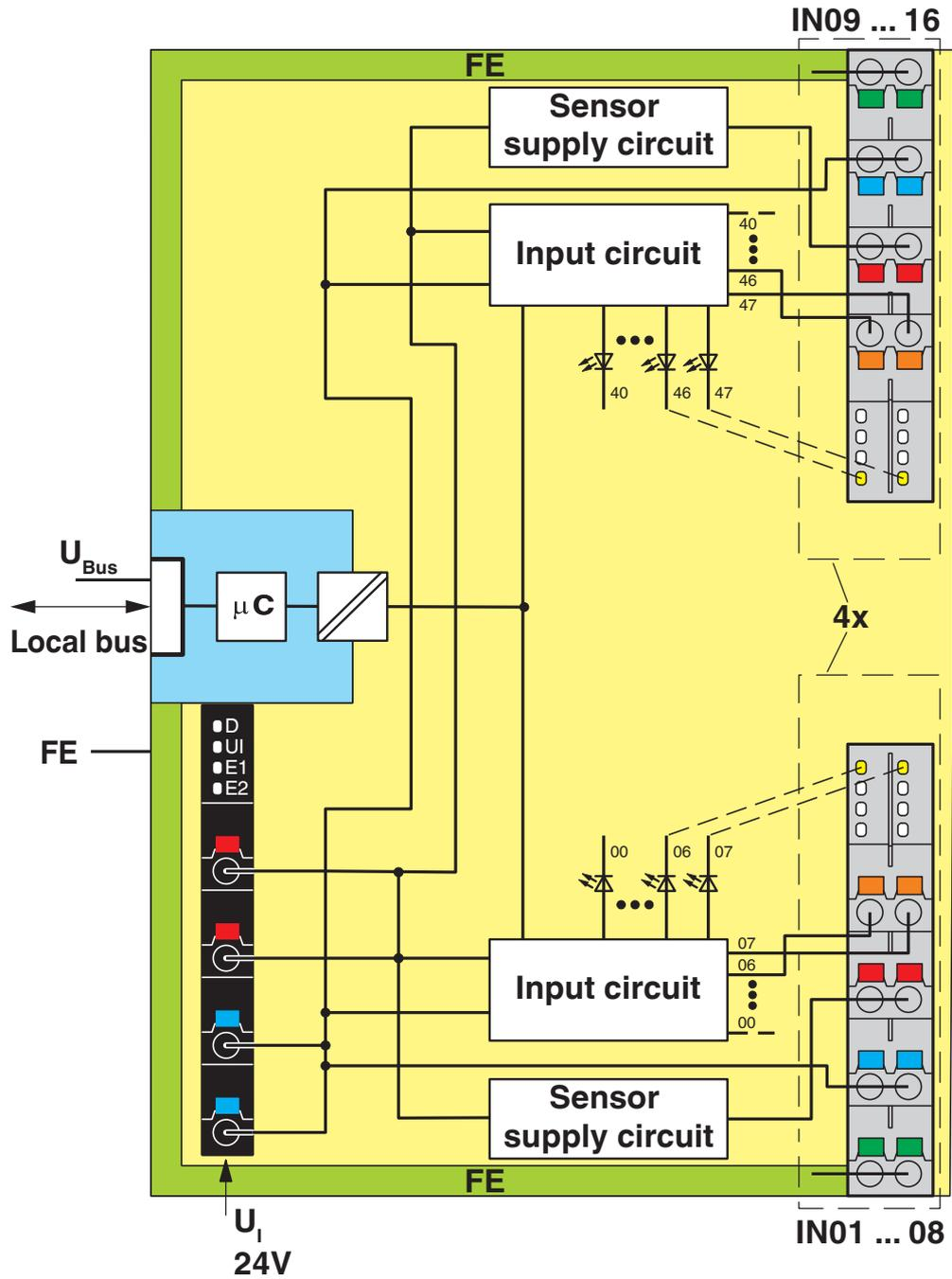
Circuito interno dei punti di connessione
