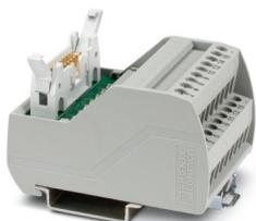
Modulo VARIOFACE con connessione a vite e connettore per cavo piatto, per l'installazione su guide di montaggio NS 35, con connettori maschio e staffe di bloccaggio corte e lunghe per connettori femmina, n. poli: 16, con LED
