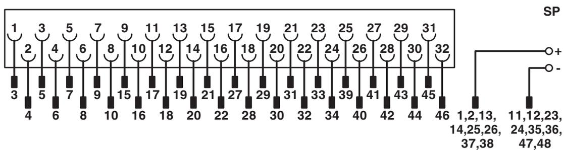
Schema di collegamento FLKM 50-PA-HW/C300
