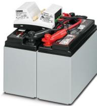
Modulo batteria (dispositivo con batteria), piombo AGM, tecnologia VRLA, 24 V DC, 13 Ah, sostituzione batteria senza utensili, riconoscimento automatico e comunicazione con QUINT UPS-IQ
