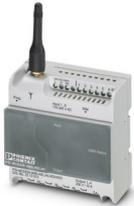
Sistema di telecontrollo SMS e di segnalazione per il montaggio su guida EN. Apparecchi installati a incasso secondo DIN 43880. 6 ingressi digitali e 4 uscite relè. Tensione di alimentazione 240 V AC. Componenti della fornitura: relè SMS, antenna, software, cavo RS-232.
