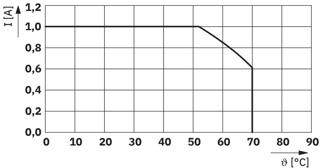
Corrente max. ammessa per circuito in stato di svolgimento
