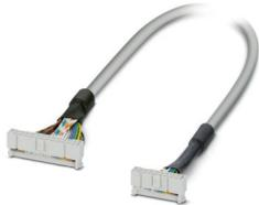
Cavo intestato; controllore: Emerson Delta V; connessione 1: IDC/FLK conduttore femmina (1x 24-poli); connessione 2: IDC/FLK conduttore femmina (1x 16-poli); lunghezza cavo: 0,3 m
