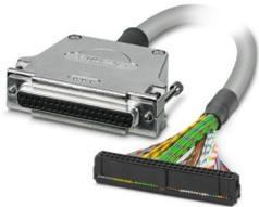
Cavo intestato; controllore: Mitsubishi Electric MELSEC Q (X81); connessione 1: Connettore femmina D-SUB (1x 37-poli); connessione 2: IDC/FLK conduttore femmina (1x 50-poli); lunghezza cavo: 0,5 m
