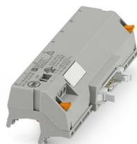
Adattatore V8 per 8 x PLC-INTERFACE (14 mm), controllore: Cablaggio di sistema PLC delle schede di uscita, collegamento 1: Connettore maschio IDC/FLK 1x 14-poli, collegamento 2: Attacco connettore (Può essere agganciato a scatto su 8 morsetti PLC-INTERFACE), collegamento 3: Connessione a vite 1x 2-poli, numero di canali: 8, logica di comando: a commutazione positiva
