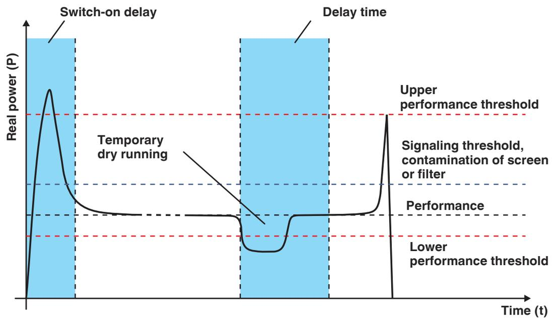
Controllo dello stato: bolle d'aria in pompe azionate da motore
