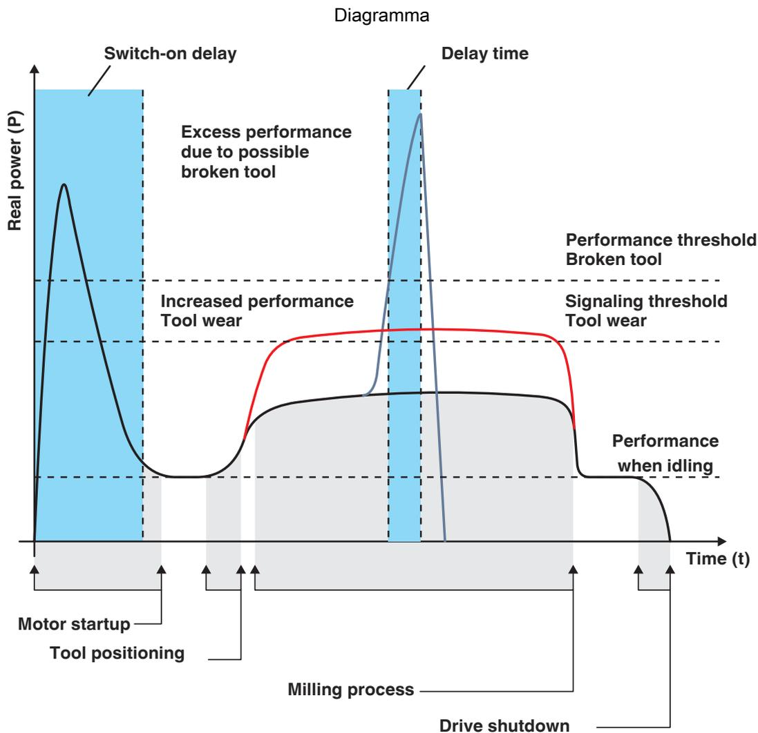
Controllo dello stato: macchina utensili durante la fresatura
