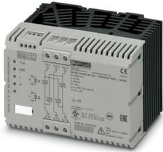
Relè invertitore di carico trifase per semiconduttori con ingresso 24 V DC, corrente d'uscita 37 A, interruttore a tensione zero, su richiesta con fusibile termico
