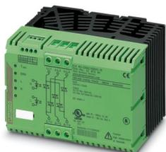
Relè invertitore di carico trifase per semiconduttori con ingresso 230 V AC, corrente d'uscita 16 A, interruttore a tensione zero, su richiesta con fusibile termico
