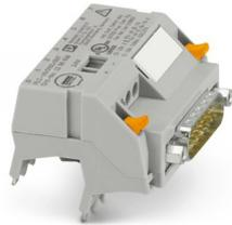
Adattatore V8 per 8 x PLC-INTERFACE (6,2 mm), controllore: Cablaggio di sistema PLC delle schede di uscita, collegamento 1: Connettore maschio D-SUB 1x 15-poli, collegamento 2: Attacco connettore (Può essere agganciato a scatto su 8 morsetti PLC-INTERFACE), collegamento 3: Connessione a vite 1x 2-poli, numero di canali: 8, logica di comando: a commutazione positiva
