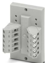
Il modulo passaparete VARIOFACE realizza un collegamento 1:1 tra morsetti con connessione a vite estraibili e un connettore femmina D-SUB (n. poli 9). È disponibile un collegamento a terra separato.
