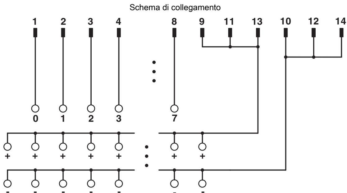
Schema di collegamento FLKMS 14/8IM/PLC
