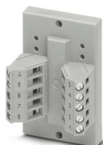
Il modulo passaparete VARIOFACE realizza un collegamento 1:1 tra morsetti con connessione a vite estraibili e un connettore maschio D-SUB (n. poli 9). È disponibile un collegamento a terra separato.
