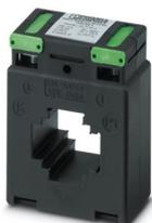
Trasformatore di corrente ad innesto, corrente primaria 150 A AC; corrente secondaria 5 A AC; classe di precisione 1; potenza nominale 3,75 VA
