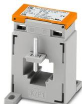
Trasformatore di corrente ad innesto, corrente primaria 200 A AC; corrente secondaria 5 A AC; classe di precisione 1; potenza nominale 5 VA
