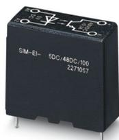
Relè a stato solido di ingresso, con protezione nei circuiti di ingresso e uscita, ingresso: 5 V DC, uscita: 8 - 48 V DC/100 mA
