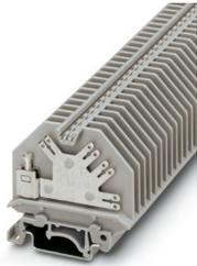
Morsetto passante, tensione nominale: 800 V, corrente nominale: 32 A, 1. Piano attacco sinistra, tipo di connessione: Connessione a vite, Sezione di dimensionamento: 4 mm<sup>2</sup>, sezione: 0,2 mm<sup>2</sup> - 4 mm<sup>2</sup>, tipo di connessione: Connessione Faston, montaggio: NS 35/7,5, NS 35/15, NS 32, colore: grigio
