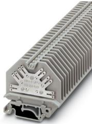
Morsetto passante, tensione nominale: 800 V, corrente nominale: 40 A, numero di connessioni: 12, tipo di connessione: Connessione Faston, 1. piano, sezione: 0,5 mm<sup>2</sup> - 6 mm<sup>2</sup>, tipo di montaggio: NS 35/7,5, NS 35/15, NS 32, colore: grigio
