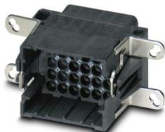
Insetto contatti, Serie di prodotti: VARIOCON, tipo: VC2, numero poli: 30, sezione del conduttore min.: 0,14 mm<sup>2</sup>, sezione del conduttore max.: 1,5 mm<sup>2</sup>, tensione di dimensionamento: 250, corrente nominale: 10 A, Tipo di connessione: Connessione a crimpare, i connettori possono essere estratti esclusivamente in assenza di tensione.
