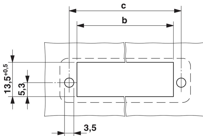
Misura b:  $10,84 \text{ mm} + (n. \text{ poli} \times 5,08 \text{ mm})$
