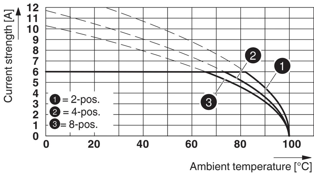
Curva di declassamento per: PTSM 0,5/...-P-2,5 con PTSM 0,5/...-HV-2,5-THR R...
