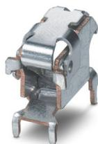
Morsetto per c.s. per conduttori flessibili zincati ad es. del tipo PV 1-F, corrente nominale: 41 A, n. poli: 1, connessione: a molla, montaggio: THT/THR, informazioni per l'utente sulla tecnologia Through Hole Reflow sono disponibili all'indirizzo: [combicon.com](http://combicon.com)
