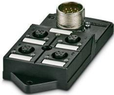
Scatola di distribuzione, applicazione: Standard, tipo di connessione: Connettore femmina M12 Plastica, numero degli slot: 4, numero poli: 5, codifica: A, occupazione slot: doppi, segnalazione di stato: no, Universale; connessione linea principale: Connessione M23 90°, schermatura: no
