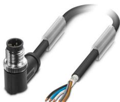
Cavo sensore/attuatore, 5-poli, PUR senza alogenati, grigio-nero RAL 7021, schermata (Advanced Shielding Technology), Maschio angolato M12, codifica: A, su estremità conduttore libera, lunghezza cavo: 1,5 m
