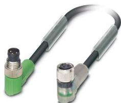
Cavo sensore/attuatore, 3-poli, PUR senza alogenati, grigio-nero RAL 7021, Maschio angolato M8, codifica: A, con 2 LED, su Connettore femmina angolato M8, codifica: A, con 2 LED, lunghezza cavo: 1,5 m
