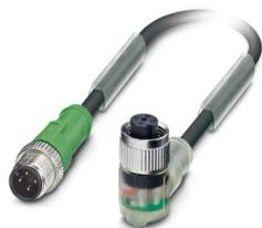
Cavo sensore/attuatore, 4-poli, PUR senza alogenati, grigio-nero RAL 7021, Maschio dritto M12, codifica: A, con 3 LED, su Connettore femmina angolato M12, codifica: A, con 3 LED, lunghezza cavo: 5 m
