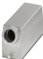
Custodia mobile, per bloccaggio longitudinale, altezza 60 mm, senza attacco a vite, 1x Pg21 uscita cavo laterale
