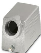
Custodia mobile, per bloccaggio longitudinale, altezza 52 mm, senza attacco a vite, 1x Pg16 uscita cavo laterale
