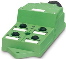
Scatola di distribuzione, tipo di connessione: Connettore femmina M12 Plastica, numero degli slot: 4, numero poli: 4, codifica: A, occupazione slot: singolo, segnalazione di stato: sì, PNP; connessione linea principale: Connessione a molla 180°, schermatura: no
