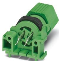
Passaparete, per il montaggio sulla parete interna, con connessione a saldare su circuito stampato lungh. del pin a saldare: 3,8 mm, foro Ø 2 poli = 19,0 mm - 0,3
