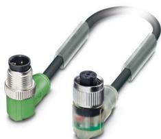
Cavo sensore/attuatore, 4-poli, PUR senza alogenati, grigio-nero RAL 7021, Maschio angolato M12, codifica: A, con 3 LED, su Connettore femmina angolato M12, codifica: A, con 3 LED, lunghezza cavo: 3 m
