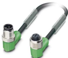
Cavo sensore/attuatore, 3-poli, PUR senza alogenati, grigio-nero RAL 7021, Maschio angolato M12, codifica: A, su Connettore femmina angolato M12, codifica: A, PIN 2+4 ponticellati, lunghezza cavo: 3 m
