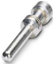
Contatto a crimpare, serie: HC-M-06, Spina, tornito, diametro contatti: 2,5 mm, sezione di connessione: 0,5 mm<sup>2</sup> ... 0,5 mm<sup>2</sup>, AWG 20...20, materiale contatti: Lega di rame
