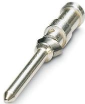
Contatto a crimpare, serie: HC-M-12, Spina, tornito, diametro contatti: 1,6 mm, sezione di connessione: 0,5 mm<sup>2</sup> ... 0,5 mm<sup>2</sup>, AWG 20...20, materiale contatti: Lega di rame
