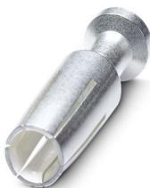
Contatto a crimpare, serie: HC-M-03, Femmina, tornito, diametro contatti: 4 mm, sezione di connessione: 6 mm<sup>2</sup> ... 6 mm<sup>2</sup>, AWG 10...10 , materiale contatti: Lega di rame
