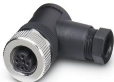
Connettore, Universale, 5-poli, Femmina angolato M12, codifica: A, Connessione a vite, materiale zigrinato: Pressogetto di zinco, nichelato, connessione a vite per cavo Pg7, diametro esterno conduttore 4 mm ... 6 mm
