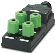
Scatola di distribuzione, applicazione: Standard, tipo di connessione: QUICKON, 0,34 mm<sup>2</sup> ... 0,75 mm<sup>2</sup>, numero degli slot: 4, numero poli: 4, occupazione slot: singolo, segnalazione di stato: sì, PNP; connessione linea principale: Connessione a molla 180°, schermatura: no
