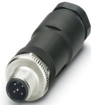
Connettore, Universale, 5-poli, Maschio diritto M12, codifica: A, Connessione a vite, materiale zigrinato: Pressogetto di zinco, nichelato, connessione a vite per cavo Pg11-DUO, diametro esterno conduttore 2,1 mm ... 3 mm / 4 mm ... 5,2 mm
