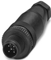
Connettore, Universale, 5-poli, Maschio diritto M12, codifica: A, Connessione a vite, materiale zigrinato: Plastica, connessione a vite per cavo Pg7, diametro esterno conduttore 4 mm ... 6 mm
